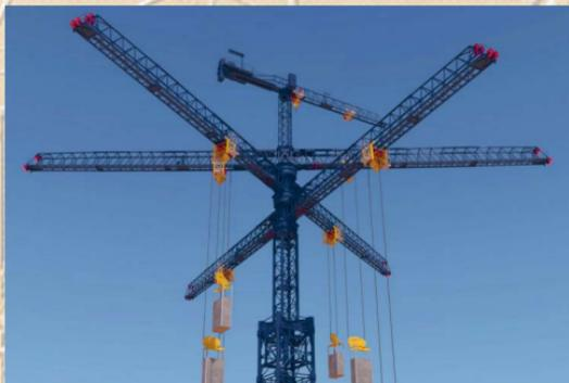
Подъем и спуск тяжелых блоков представляется выгодным и выверенным решением. Его можно применять и для хранения солнечной и ветровой энергии впрок, чтобы снизить зависимость от угля, нефти и газа.
