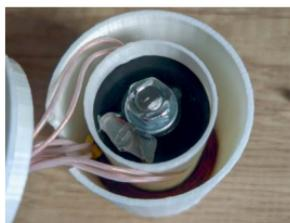
Рис. 7. Корпус электромагнита.
